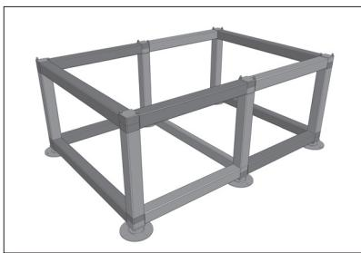
После сборки каркаса измерьте диагонали пролетов. Расхождение должно быть не более 3 мм. По завершению замеров и коррекции затяните все болтовые соединения.
